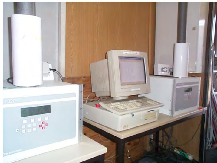
Abbildung 7: Messgeräte BAM-1020 in Messstation
