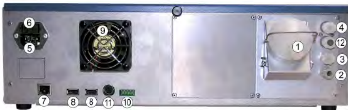
(1) Probegaseingang, (2) Pumpenausgang, (3) Nulllufteingang, (4) Prüfgaseingang, (5) dreipoliger Netzanschluss, (6) Hauptsicherung, (7) Ethernet-Ausgang, (8) zwei USB-Anschlüsse, (9) Ventilator, (10) Rückmeldung MV Nullluft und Prüfgas für das optionale externe Kalibrier-MV, (11) 24-V-Versorgung für optionale ESTEL-Karte, (12) not used.
