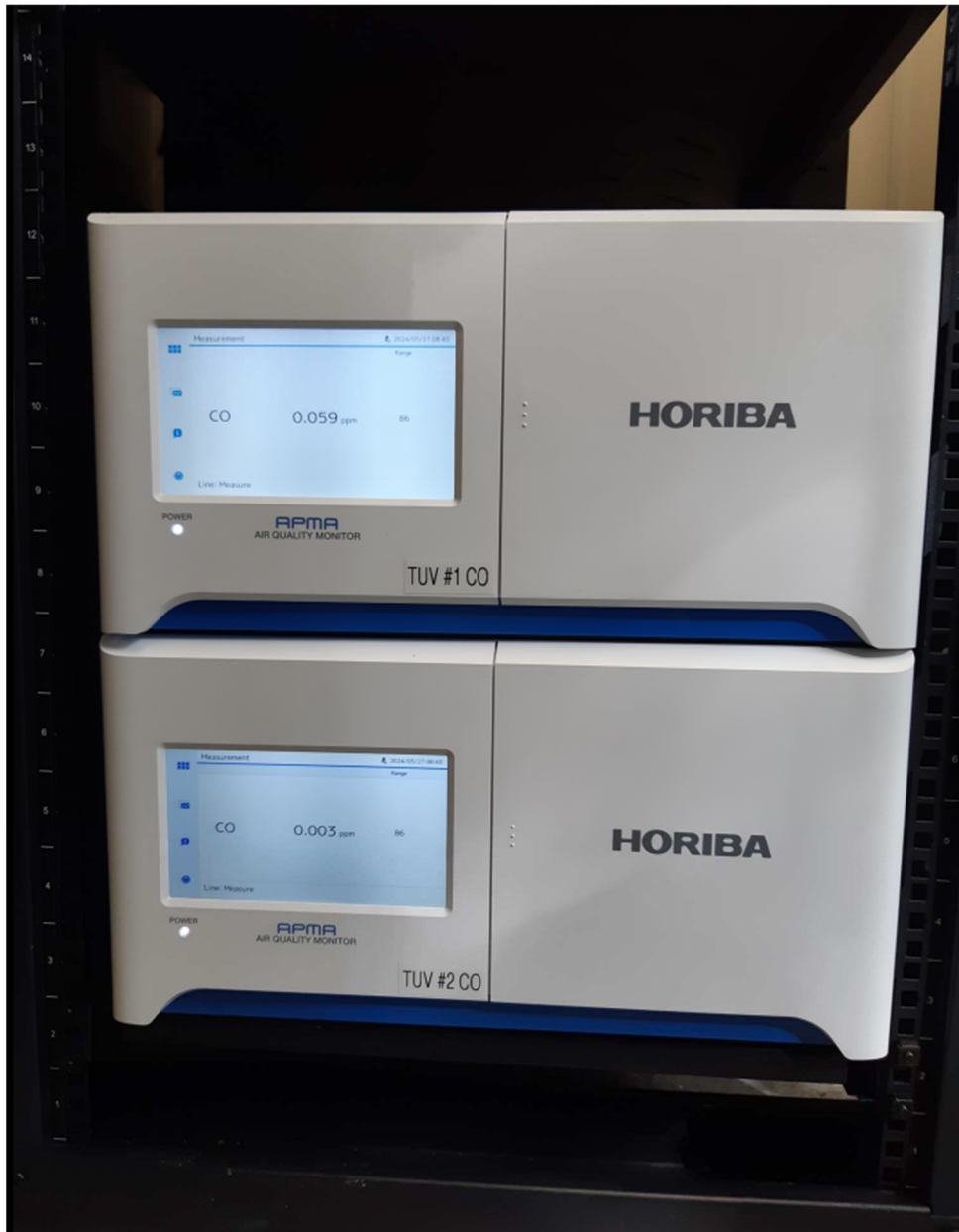
Abbildung 6: APMA-380 in der Messstation während des Feldtests
