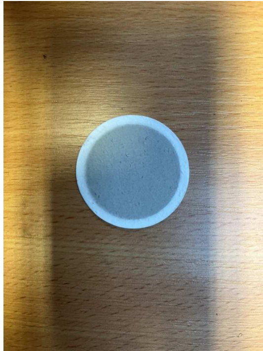
Abbildung 12: Membranfilter (EMFAB) nach > 24 h-Probenahme
