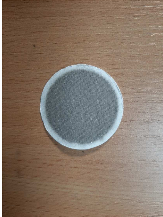
Abbildung 13: Faserbasierter Filter (Quarzfaser) nach > 24 h-Probenahme
