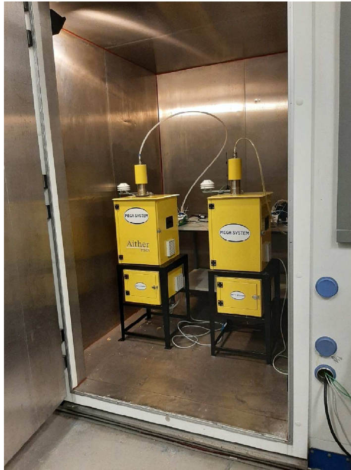
Abbildung 3: Aufbau AITHER PMS in Klimakammer
