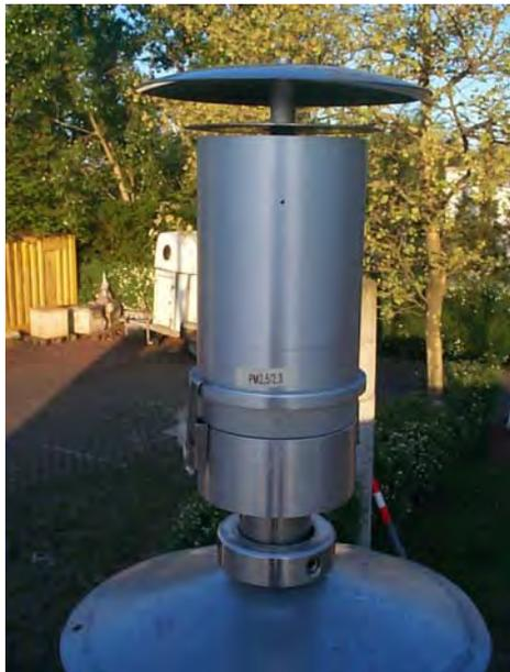
Abbildung 2: PM<sub>2,5</sub>-Probenahmekopf für OPSIS SM 200 ( $2,3 \text{ m}^3/\text{h}$ )
