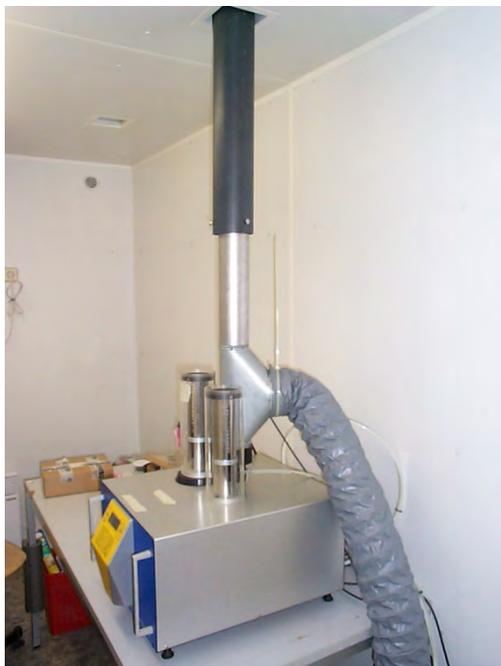
**Abbildung 5:** Temperaturstabilisator TS 200 für Probenahmerohr (Installation im Messcontainer)
