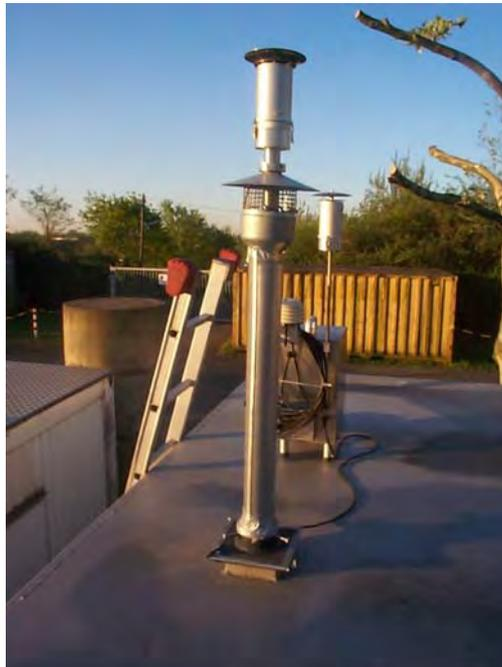
*Abbildung 4: Temperaturstabilisator TS 200 für Probenahmerohr (Installation über Dach)*
