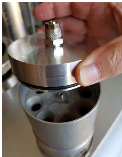
Abbildung 21: Adapter zur Bestimmung der Leckrate
