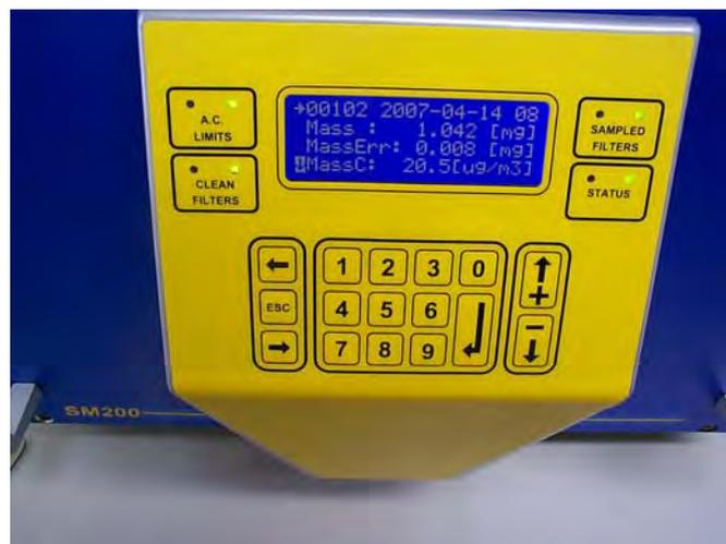
Abbildung 18: Frontalaufnahme der Bedieneinheit der Messeinrichtung mit Messwertanzeige
