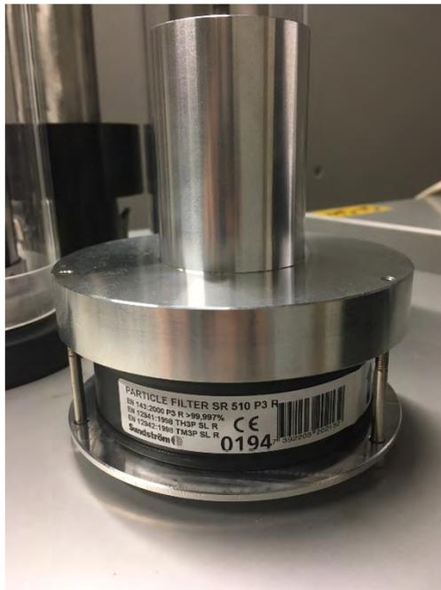
**Abbildung 10:** Absolutfilter zur Bereitstellung von schwebstaubfreier Luft
