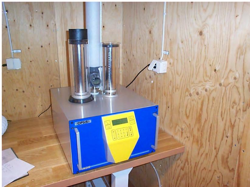
**Abbildung 7:** Probenahme- und Messeinheit
