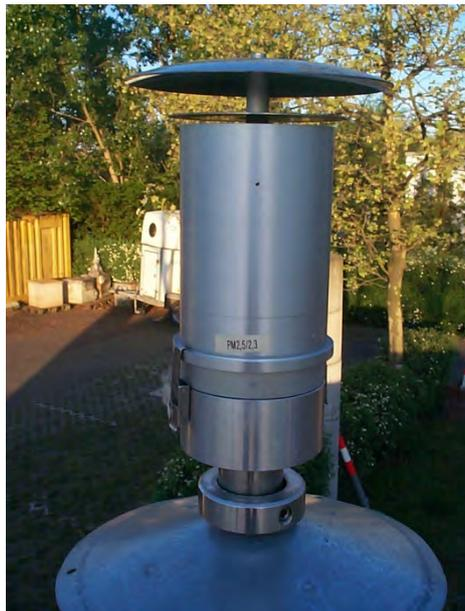
**Abbildung 2:** PM<sub>2,5</sub>-Probenahmekopf für OP SIS SM 200 (2,3 m<sup>3</sup>/h)
