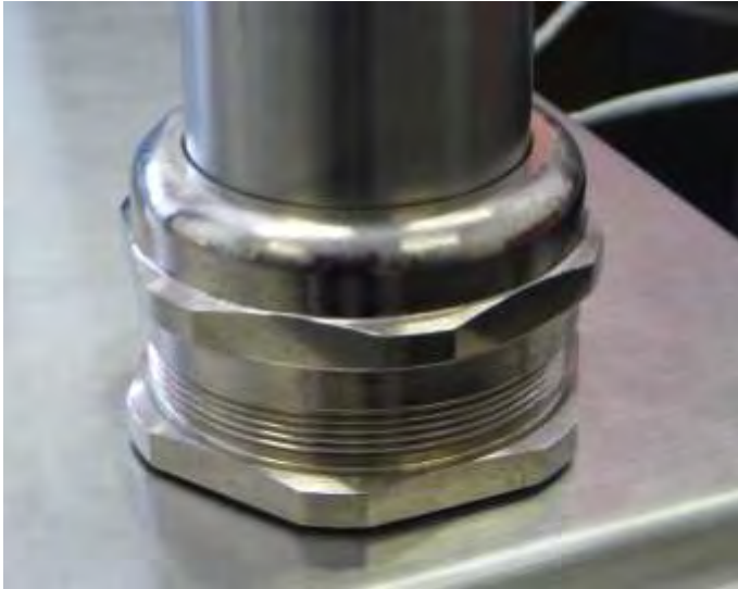
Abbildung 8: Fixierung des Wetterstationrohres
