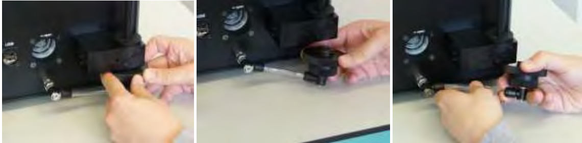
Abbildung 28 A-C: Entfernen des Filterhalters
