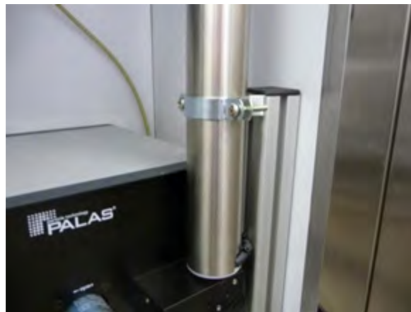
Abbildung 11: Probenahmerohr mit IADS für Fidas ® 200 S bzw. Fidas ® 200
