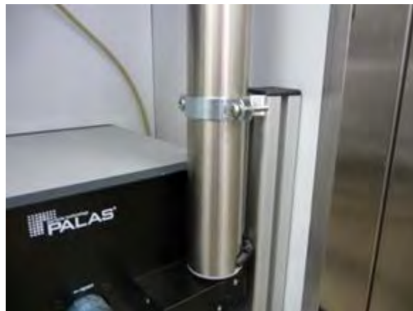
Abbildung 14: Probenahmerohr mit IADS
