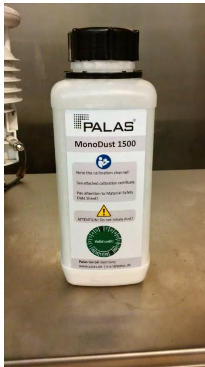
Abbildung 22: MonoDust 1500 zur Verifizierung / Kalibrierung der Empfindlichkeit
