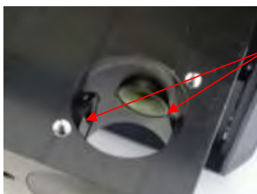
Abbildung 34: Optische Gläser im Innern des Aerosolsensors
