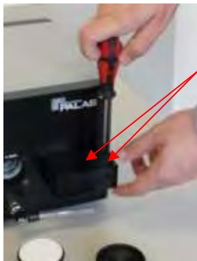
Abbildung 32: Lösen der M3 Kreuzschlitzschrauben
