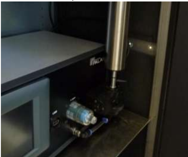
Abbildung 17: Verbinden des Probennehmerohres mit dem Probeeintrittsrohr und der Steuereinheit
