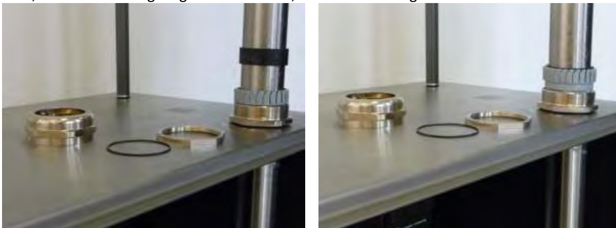
Abbildung 13 A+B: Äußere Fixierung des Probenahmerohres
