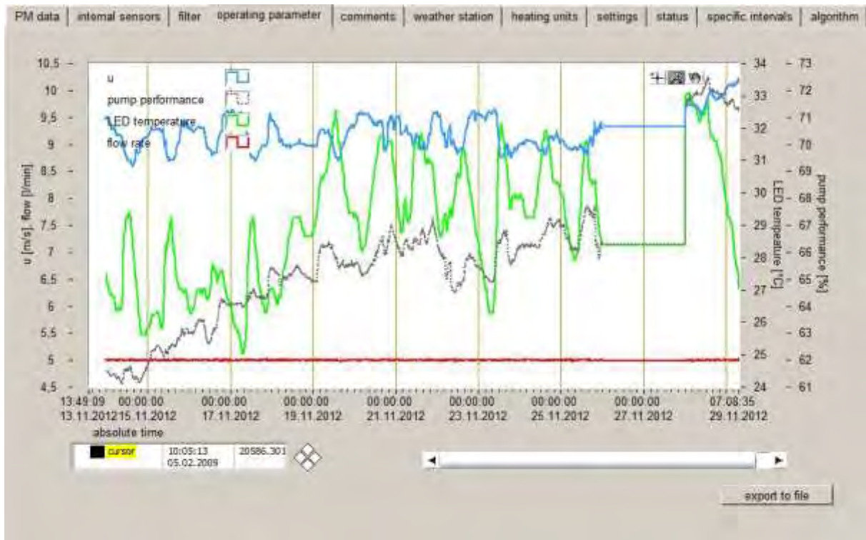
Abb.: 16: Reiter "operating parameter" – zeigt die Partikelgeschwindigkeit, Pumpenleistung, LED-Temperatur und den Durchfluss an.
