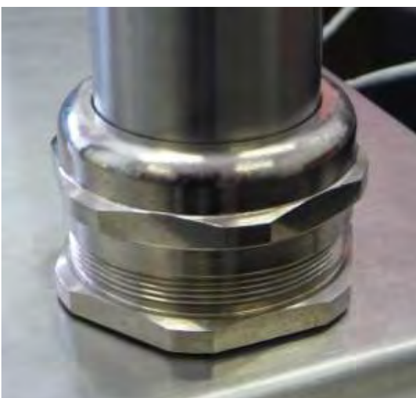
Abbildung 20 A+B: Abschließende Fixierung des Probenahmerohres
