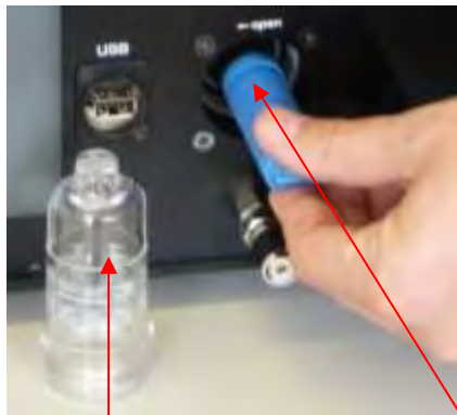
Abbildung 36: Entfernen der Schutzkappe Abbildung 37: Filter ohne Schutzkappe
