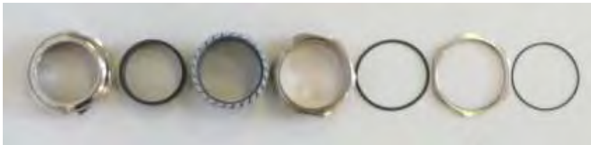
Abbildung 7: Die Bestandteile der Fixierung des Wetterstationrohres
