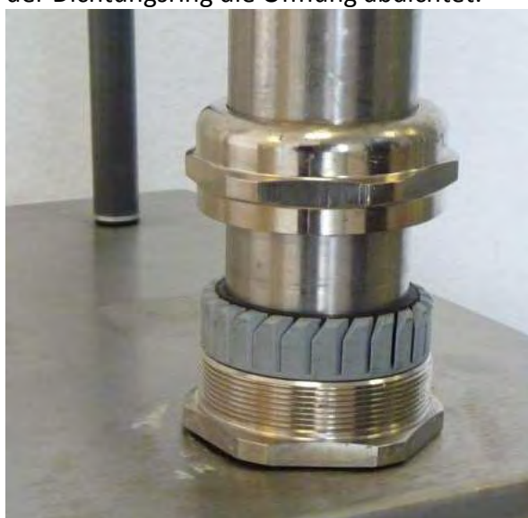
Abbildung 20 A+B: Abschließende Fixierung des Probenahmerohres
