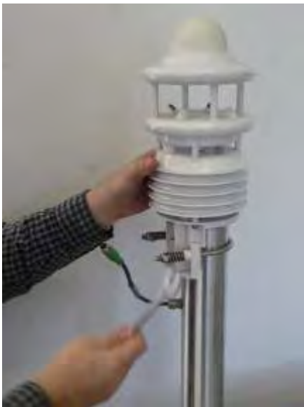
Abbildung 9: Anbringen der Wetterstation am Rohr
