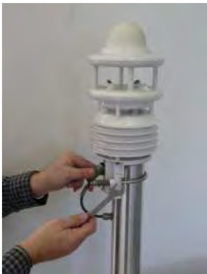
Abbildung 10: Verbinden des Kabels mit der Wetterstation
