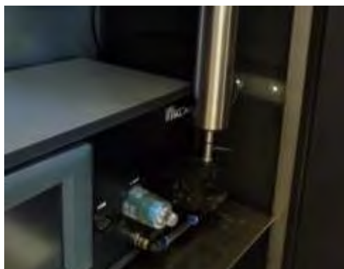
Abbildung 30: Verbindung des Sensoreingangs mit Feuchtekompensationsmodul IADS
