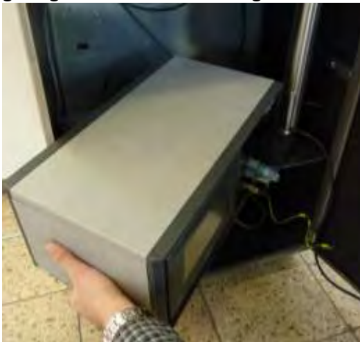
Abbildung 15: Einschub der Fidas® Steuereinheit
