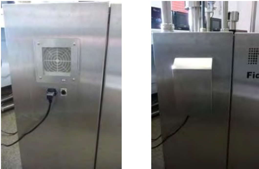
Abbildung 23 A+B: Netzanschluss des Wetterschutzgehäuses
