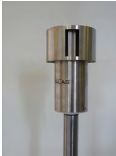
Abbildung 10: Sigma2-Probenahmekopf für Fidas ® 200 S bzw. Fidas ® 200
