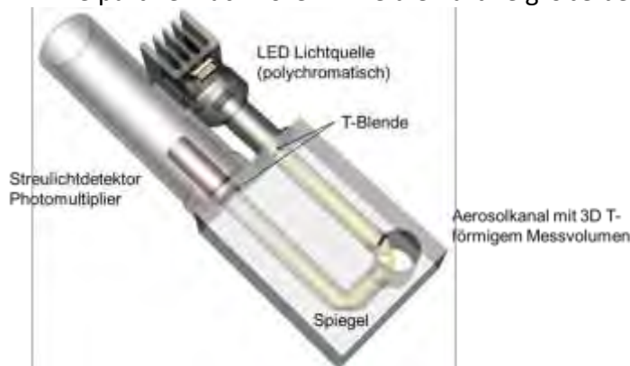
Abbildung 40: Aufbau des Sensors des Fidas® Messsystems
