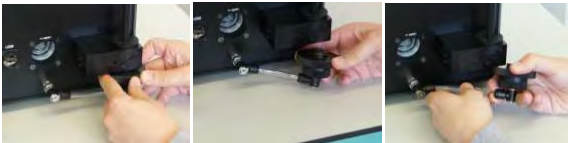
Abbildung 31 A-C: Entfernen des Filters
