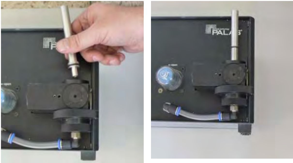
Abbildung 14 A+B: Anbringen des Aerosoleinlassführungsrohres
