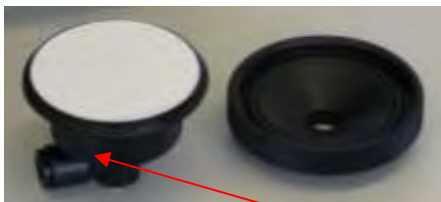
Abbildung 29A: Aufbau des Filterhalters
