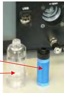
Abbildung 39: Ausgebauter Filter und Schutzkappe
