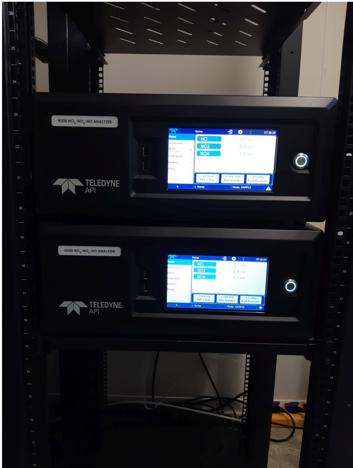
Abbildung 9: N200 in der Messstation während des Feldtests
