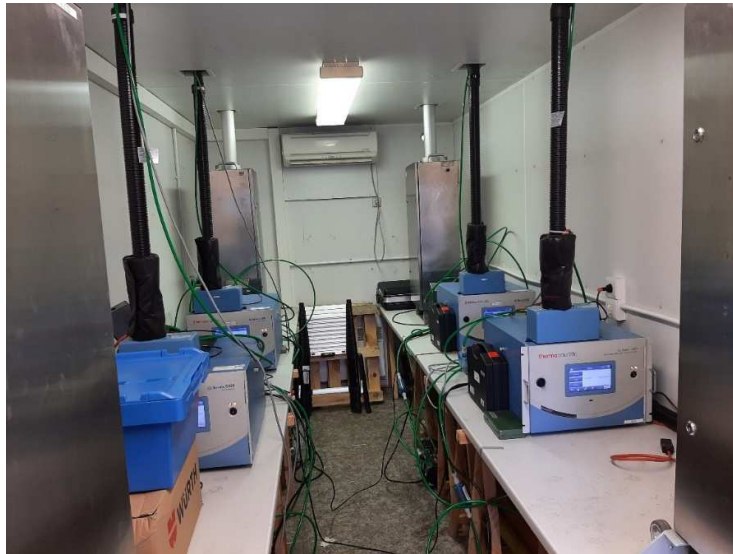
Abbildung 7: Messgerät 5014iQ in Messstation – hier als Version 5030iQ mit zusätzlichem Nephelometerbauteil (siehe auch Kapitel 3.3)
