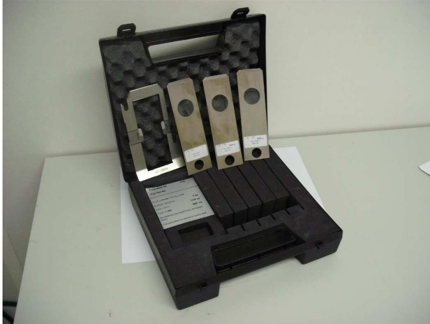
Abbildung 12: Foliensatz mit Folienhalter und Prüffolien
